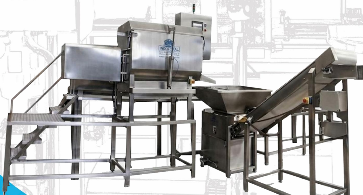
Línea de pasta hilada AT-2,000 Cooker, extrusor y banda
